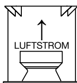
VUO Vertical Discharge Up, Ceiling Hung Support Brackets On Outlet [Vertikaler Ablass nach oben, Deckenhängung, Stützhalterungen am Ausgang]
