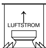
VUI Vertical Discharge Up, Floor Mount Support Brackets On Inlet [Vertikaler Ablass nach oben, bodenmontiert mit Stützhalterungen am Eingang]
